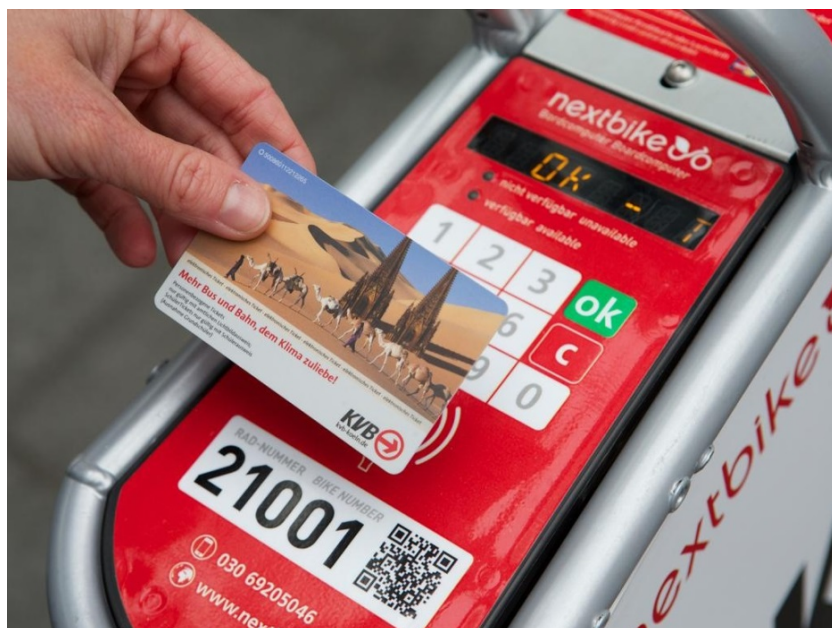
Fot. 5. Panel wypożyczeń wbudowany w rower firmy Nextbike w systemie KVB-Rad w Kolonii (fot. za: http://www.kvb-koeln.de/ )
