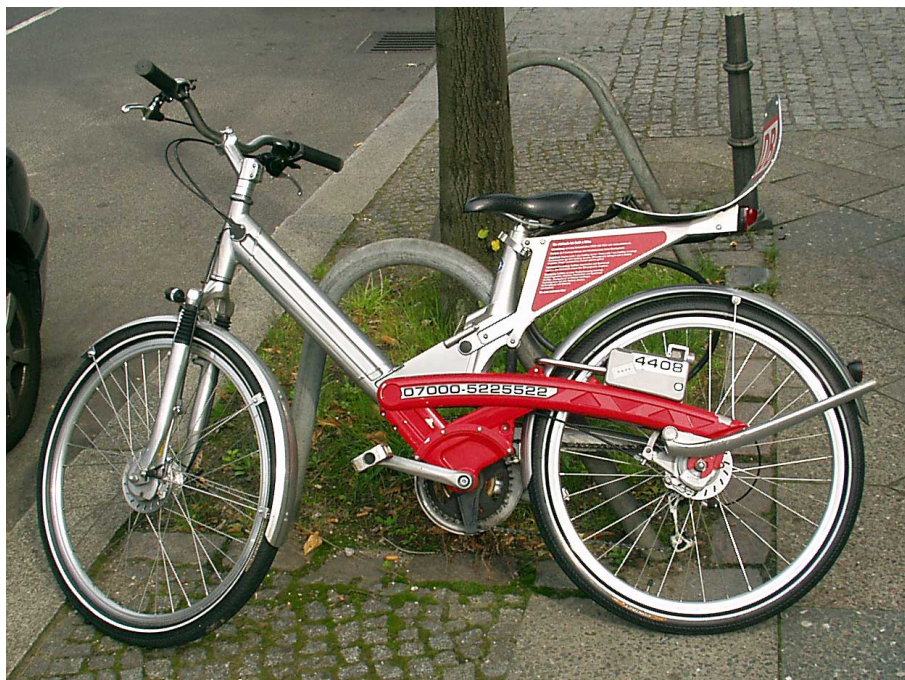
Fot. 10. Rower systemu punktowo-mieszanego Call a Bike związanego z kolejami niemieckimi Deutsche Bahn. Na tylnym kole znajduje się blokada z zamkiem z klawiaturą pozwalającą na wpisanie kodu otrzymanego przez infolinię. Na zamku widoczny jest numer roweru a na ramie numer infolinii telefonicznej. (fot za Wikipedia Commons)
