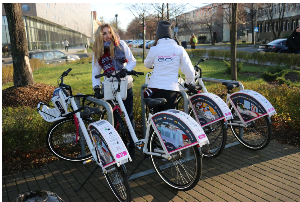
Fot. 9. Rowery SRP 4 generacji SimpliBike autorstwa wrocławskiej firmy SimpliGo. Elektroniczny panel wypożyczeń, moduł komunikacji oraz wbudowany elektrozamek wraz z zapięciem znajdują się na przednim bagażniku. Tylny błotnik zawiera instrukcję wypożyczenia oraz mały panel fotowoltaiczny. (fot. materiały operatora)
